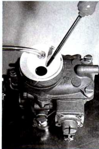
Die luftdichte Schlauchdurchführung wird zur Sicherheit verstärkt
