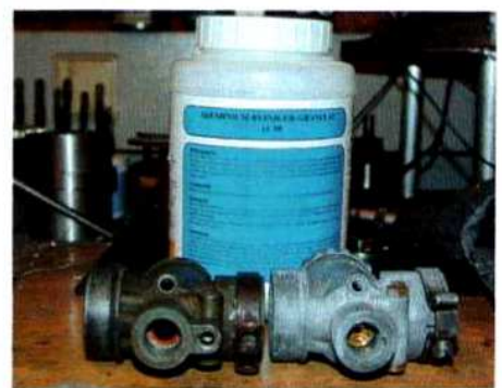
...zeitigt ähnlich gute Ergebnisse, ist aber mit Vorsicht anzuwenden, weil er Metall angreift
