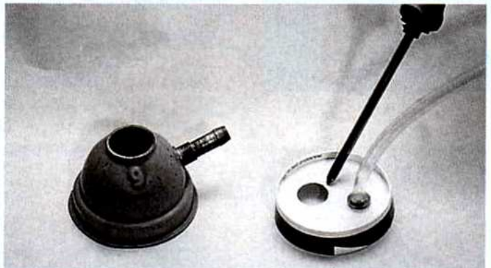
Original und „Fälschung“: Links sehen Sie den Prüfdeckel eines professionellen Synchrontesters, rechts das Modell Marke „Eigenbau“
