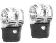
Synchrometer Typ BK mit großem Anzeige bereich von 1 bis 35 kg/h. Der Luftdurchsatz kann durch die By-Bass Öffnung zusätzlich erhöht werden. Geeignet für alle Motoren. Gummimuffe mit festem Sitz auf 47 bis 53 mm Ø Vergaserstutzen oder Adapter
